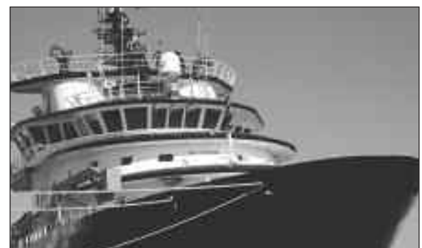
80 mètres de long, un déplacement de 3 200 tonnes et une capacité de traction au point fixe de 209 tonnes : la nouvelle génération des Abeille est parfaitement adaptée à ses missions.
